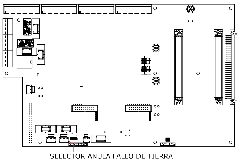
Figura 30 Posizione del selettore di override del guasto a terra
